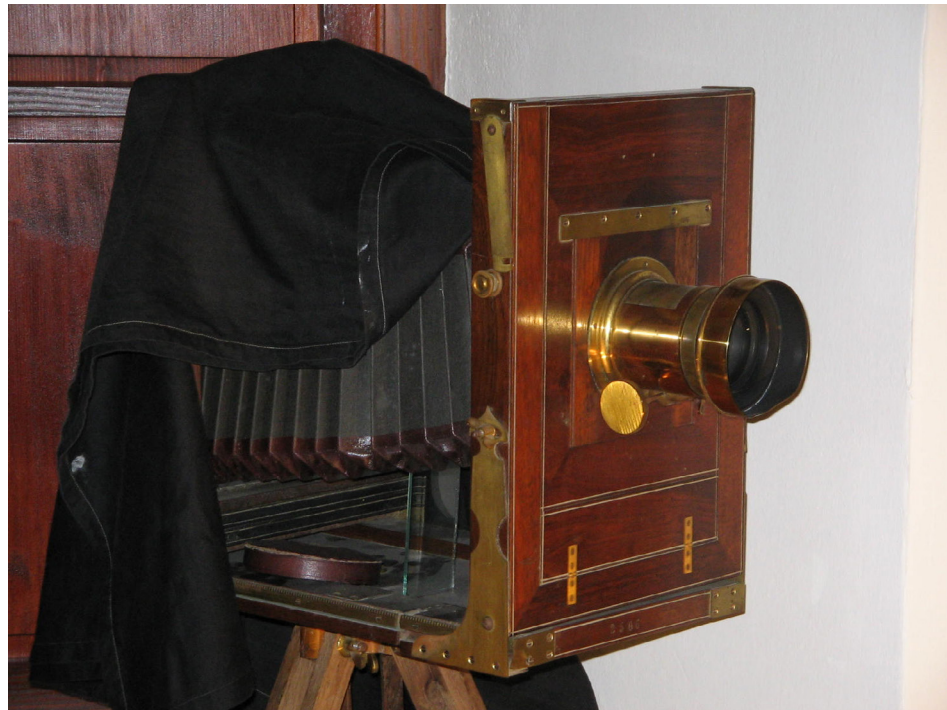
Cámara de fuelle, para negativos de vidrio, con trípode ligero para viajes.
