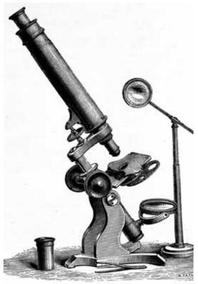
**Base o pie:** Es la pieza que se encuentra en la parte inferior del microscopio y sobre la cual se montan el resto de elementos. Acostumbra a ser la parte más pesante para proporcionar suficiente equilibrio y estabilidad al microscopio.
